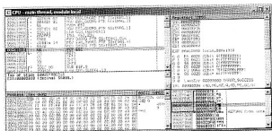
图 10.8 使用 OllyDbg 观察 f1() 执行完毕时的栈内数据
