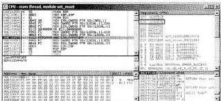
图 19.3 OllyDbg: EDX 寄存器再次加载运算结果
