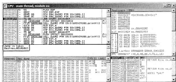
图 12.1 使用 OllyDbg : 观察 f_unsigned() 的第一个条件转移指令
